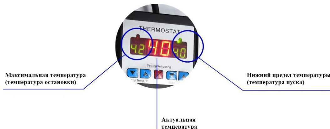
Рис. 7. Пример установки температуры
