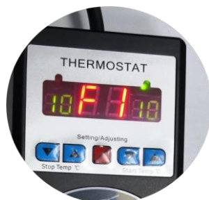
Рис. 4. Интервальный режим, F1 (пример)
