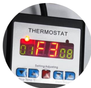
Рис. 6. Режим включения по таймеру, F3 (пример)
