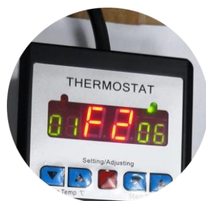
Рис. 5. Режим отключения по таймеру, F2 (пример)
